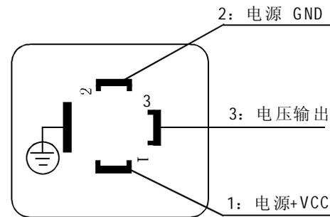
三线制电压输出型1205、1215、1210、1245
