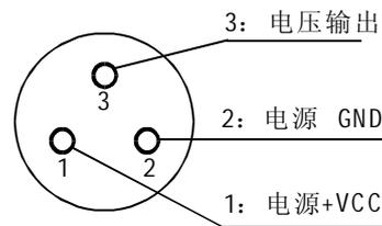
三线制电压输出型1205、1215、1210、1245
