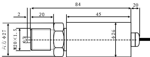
图1：防水接头引出屏蔽电线形式
