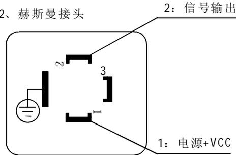
两线制电流输出型1300
